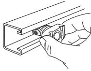
**1** Las tuercas unicanal se insertan fácilmente en cualquier punto de la ranura longitudinal. Solo presione y gire para trabar tuercas en borde 180°.
