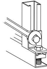
**4** Coloque y fije segundo riel para obtener una conexión rígida. Al apretar el tornillo la tuercas se encaja en el borde 180° creando una excelente conexión mecánica.
