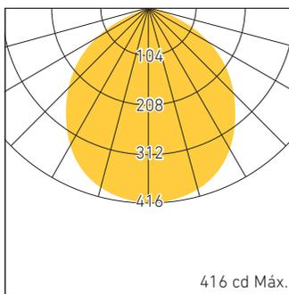
5.1 EFICIENCIA DEL SISTEMA: 68 lm/W @ 3000K
