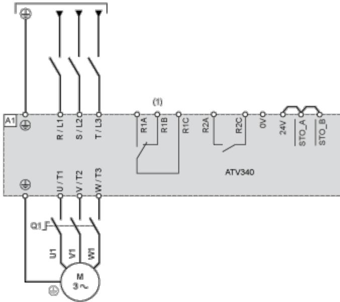
(1) Utilice la salida de relé R1 fijada en el estado de funcionamiento de fallo para apagar el producto cuando se detecte un error.
