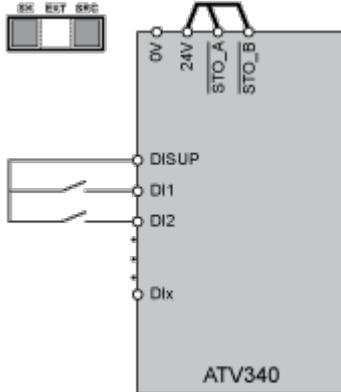
En la posición SRC, salidas DISUP de 24 V. En la posición SK, DISUP se conecta a 0 V.
