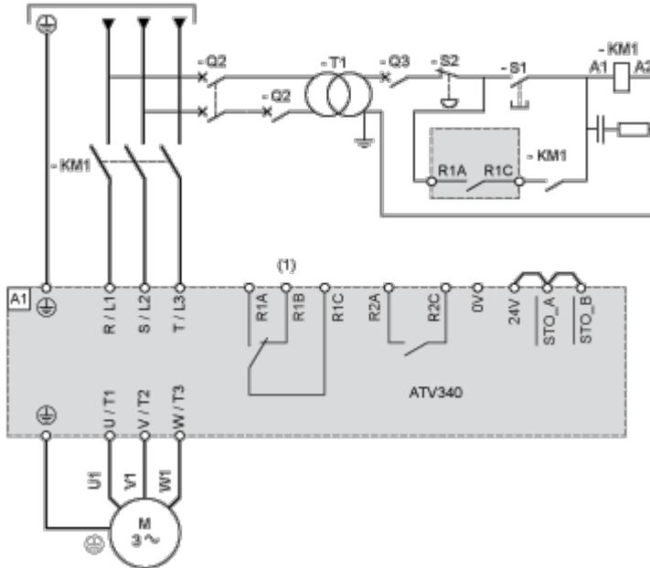
(1) Utilice la salida de relé R1 fijada en el estado de funcionamiento de fallo para apagar el producto cuando se detecte un error.
