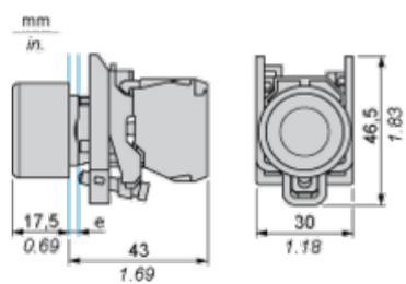
e: espesor de sujeción: de 1 a 6 mm (de 0.04 a 0.24 in)
