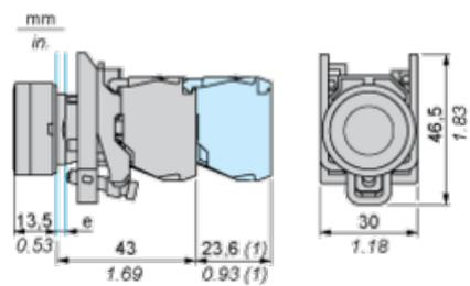
e: espesor de sujeción: de 1 a 6 mm (de 0.04 a 0.24 in)
