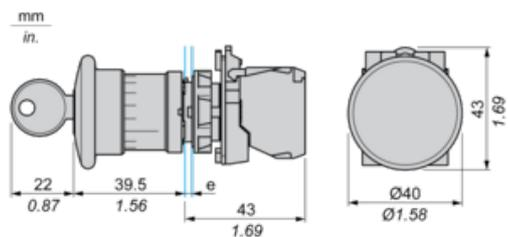
e: espesor de sujeción: de 1 a 6 mm (de 0.04 a 0.24 in)
