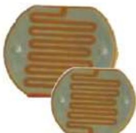
Las fotoceldas estándar son de sulfuro de cadmio, epóxicamente selladas en 1/2 pulgada (1,2 cm). Se pueden suministrar a solicitud en 1 pulgada (2,54 cm).
