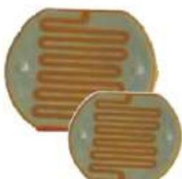
Las photoceldas estandar son de sulfuro de cadmio, epóxicamente selladas en 1/2 pulgada (1,2 cm). Se pueden suministrar a solicitud en 1 pulgada (2,54 cm).
