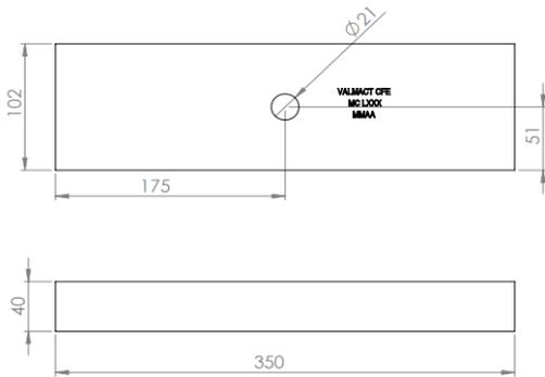
**Uso:** Fijación de tirantes en estructuras de líneas eléctricas de Media Tensión y equipo.
