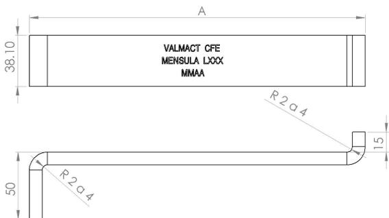
**Uso:** Con la corredera CS y perno CS, soporta cables en registros, pozos y bóvedas de distribución subterránea.
